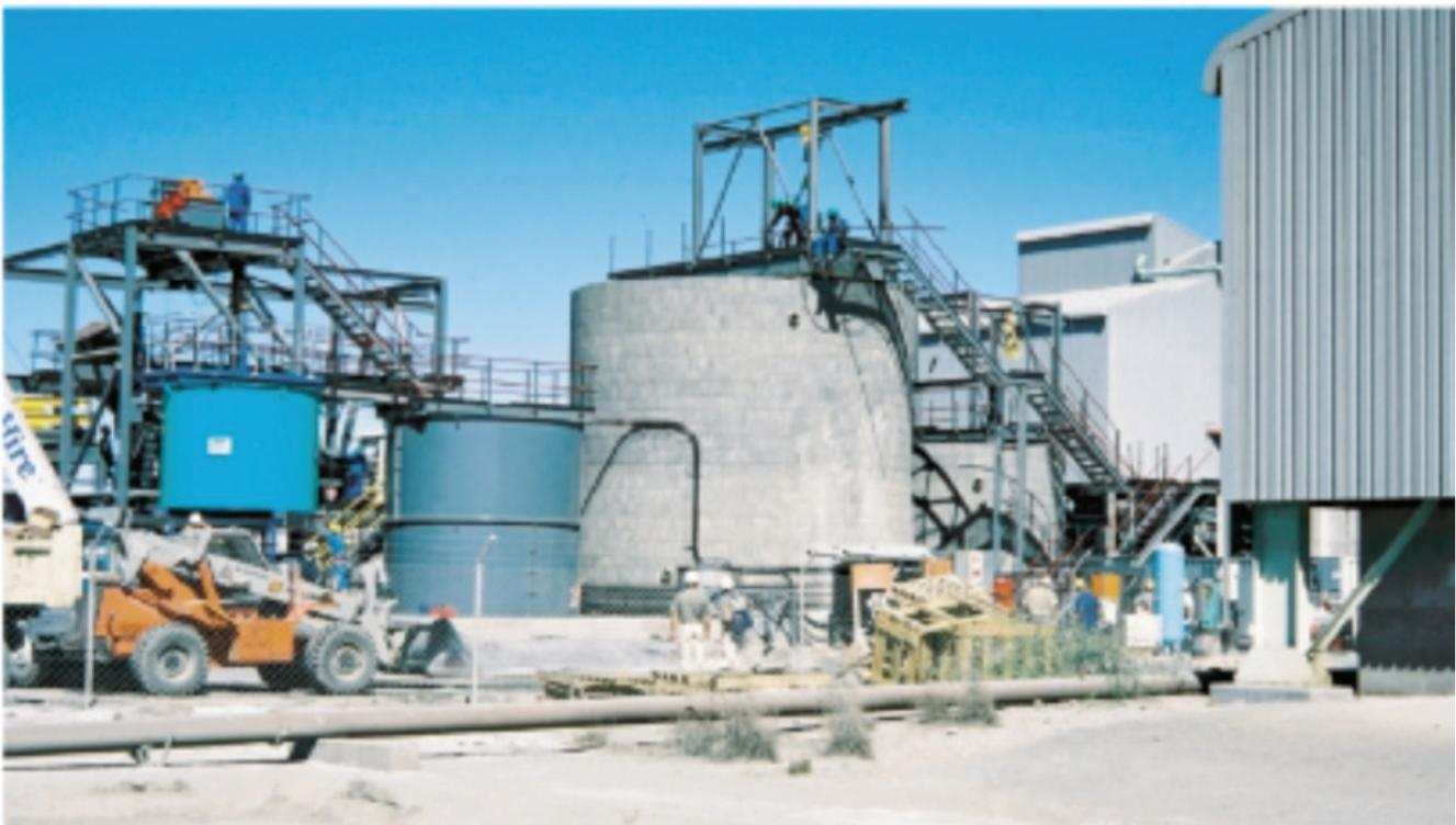
Gambar 3 Reaktor pengujian *Thermophilicarchaea* dengan kapasitas 300m<sup>3</sup>
